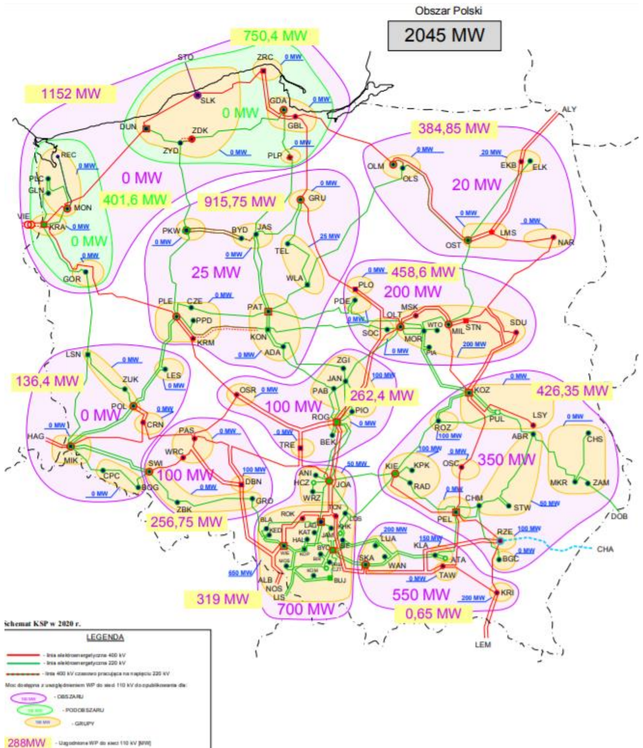
Rycina 16. Schemat sieci przesyłowej z dostępnymi mocami przyłączeniowymi Źródło: www.pse.pl
